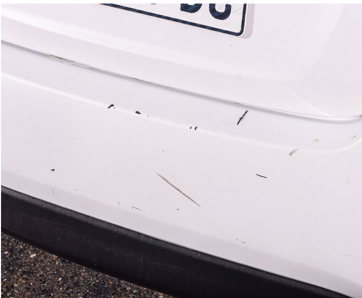
Carrocería: Posee rayas en ambos paragolpes. Posee pasaruedas flojo podría ocasionar ruidos además del desgaste que presenta
