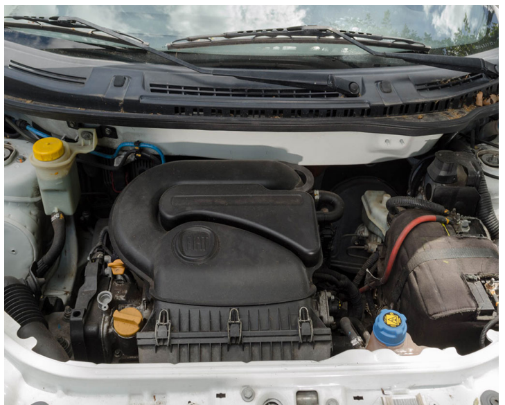
Motor: Recomendación: cambiar filtros de aceite y aire del motor, aceite del motor, correas del alternador
