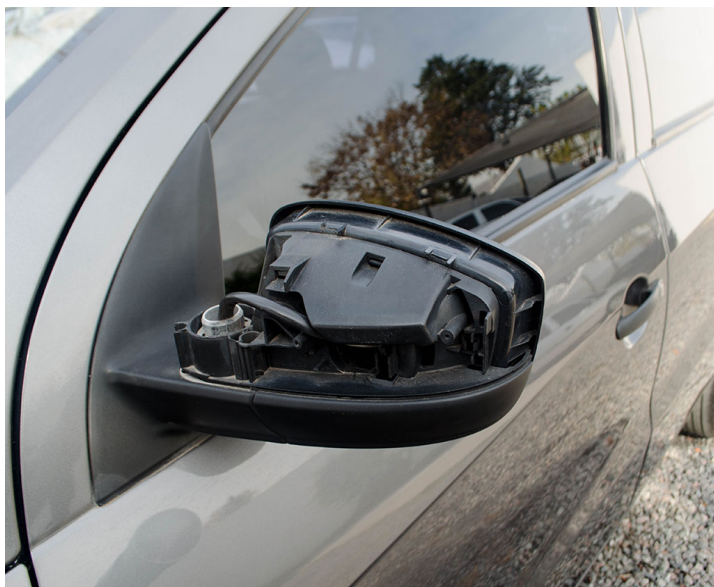
Carrocería: Retrovisor con cache faltante
